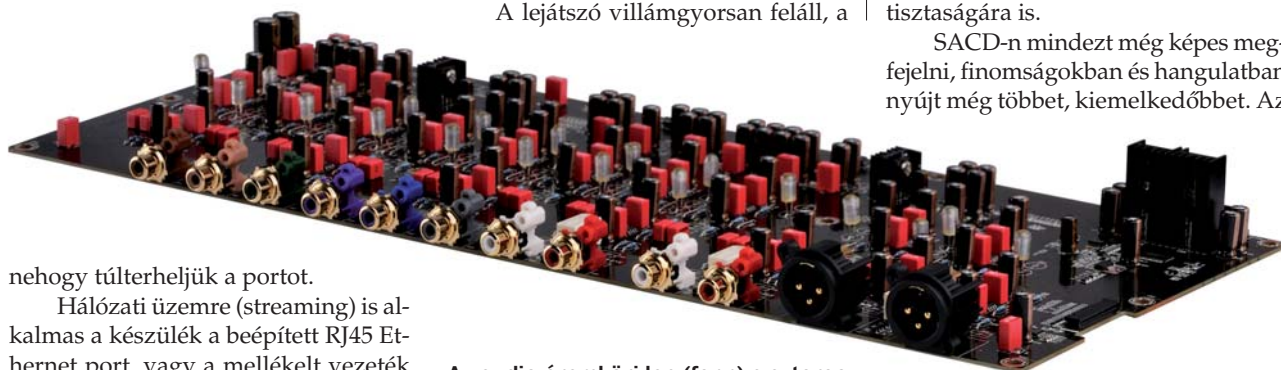
Az audio áramköri lap (fenn) a sztereo és surround kimenetekkel, és a Rotel gyártmányú hálózati transzformátor.
